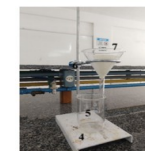
Figura 2: Sistema de filtração simples.
